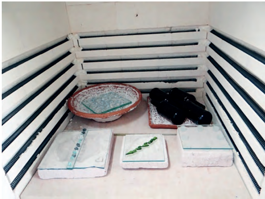
12B – Disposição das peças no forno para iniciar o processo de fusão
