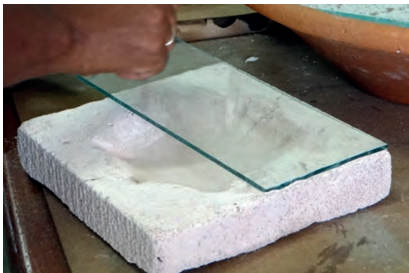
11A – Montagem de peça no molde de concreto celular
