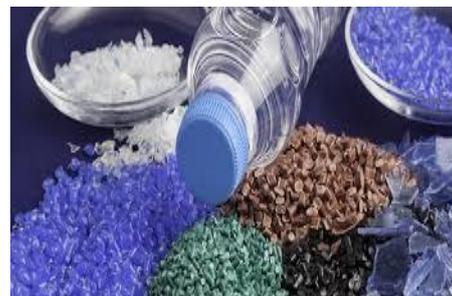
Na extrusão se utiliza uma máquina extrusora, na qual o material moído, após as etapas descritas acima, é colocado em um funil e, através do calor gerado na extrusão, forma-se a massa plástica que sai na forma de espaguete contínuo para ser resfriado, picotado e, por fim, transformado em grãos.
