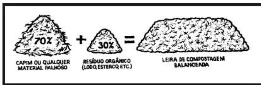
As pilhas ou leiras devem ser confeccionadas obedecendo a altura máxima de 1,80 metros evitando assim a compactação da pilha e “fuga” do oxigênio do sistema, favorecendo a degradação ativa do composto através das bactérias aeróbicas.
